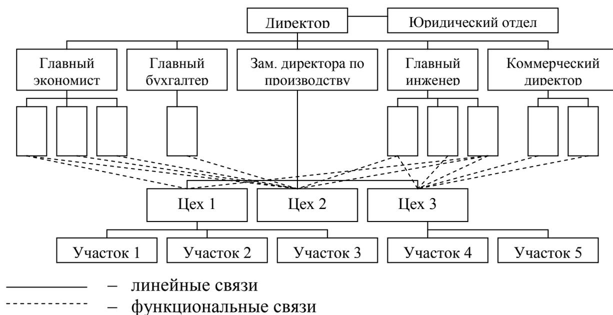
Рис. 6.4. Схема линейно-функциональной (штабной) организационной структуры управления
